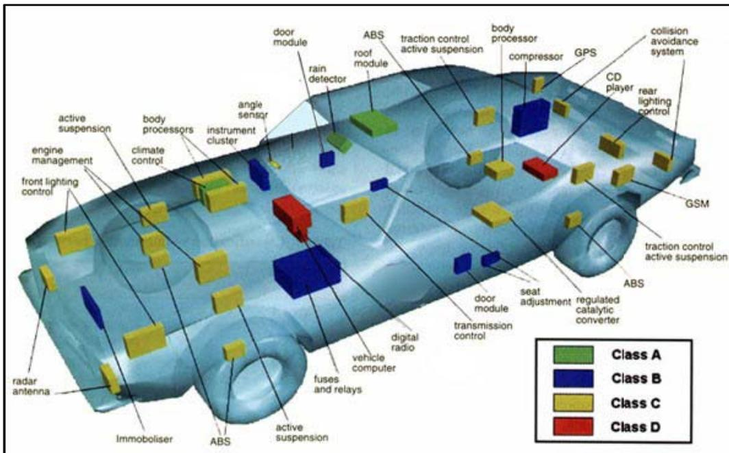
클래스 A 네트워크들은 전자 부트 작동기 (electronic boot release), 전동 거울 조정장치, 비 탐지, 쉐르프, 기상 관리 등과 같은 편의 기능 또는 고급 기능들에 일반적으로 사용되며 10 Kbit/s 미만으로 작동합니다.
